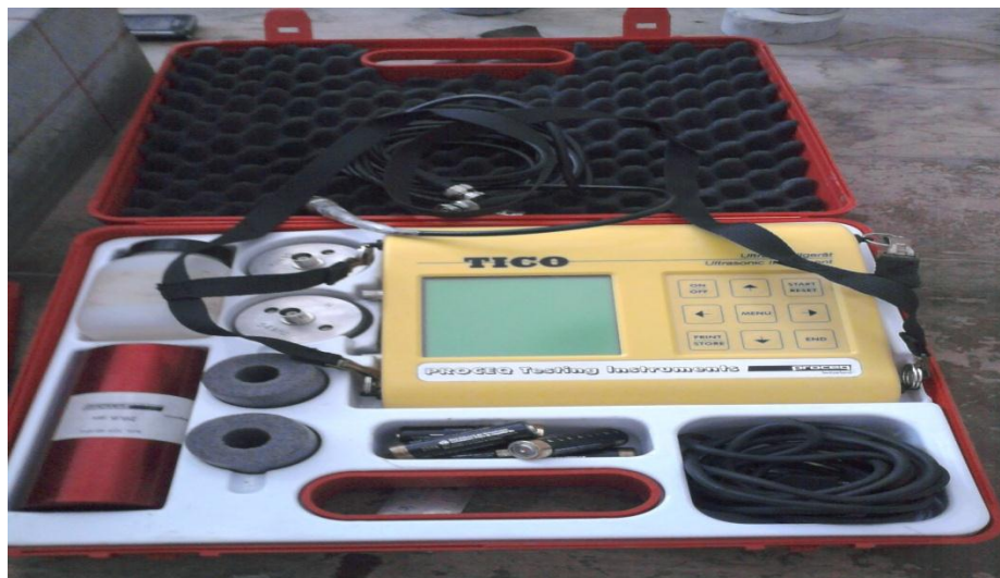
Fig.5.9. Complete U.P.V apparatus/kit
